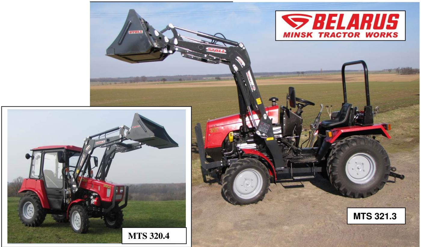
**Mit Schaufel 1.4m und Schnellwechselrahmen Skid Steer**
