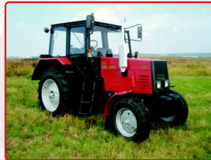
Niedrigkabine für alle Typen, minimale Höhe nur 2,45 m
