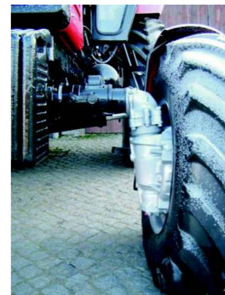
Allradantrieb, Portalachse, hohe Bodenfreiheit, maximale Wendigkeit, ideal für Pflegearbeiten und Fahren auf engen Höfen MTS 572 und 820
