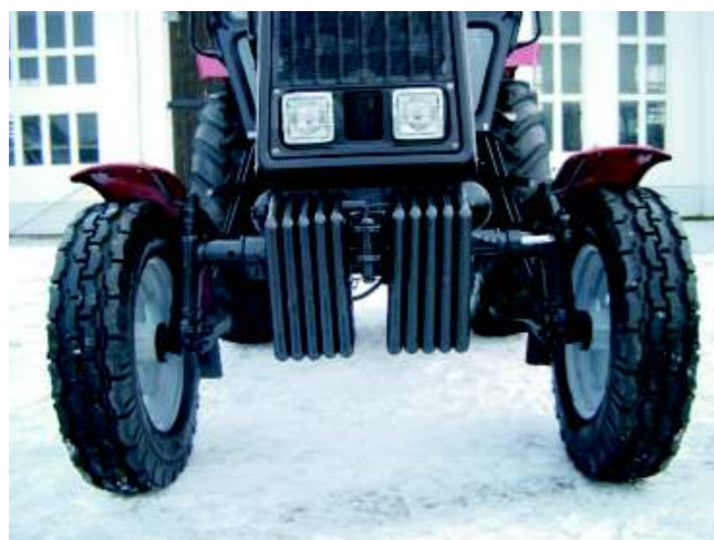
Vorderachse ohne Antrieb, einfach - wendig - preisgünstig MTS 570 und 800
