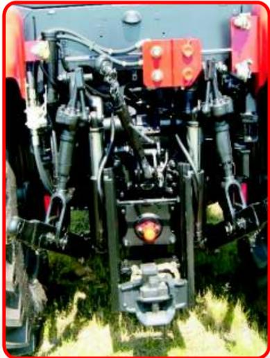
Das Hubwerk mit zwei stehenden Zylindern erreicht bis zu 4,5t Hubkraft, dazu Oberlenkerregelung mit Zugkraft-, Lage- und Mischregelung
