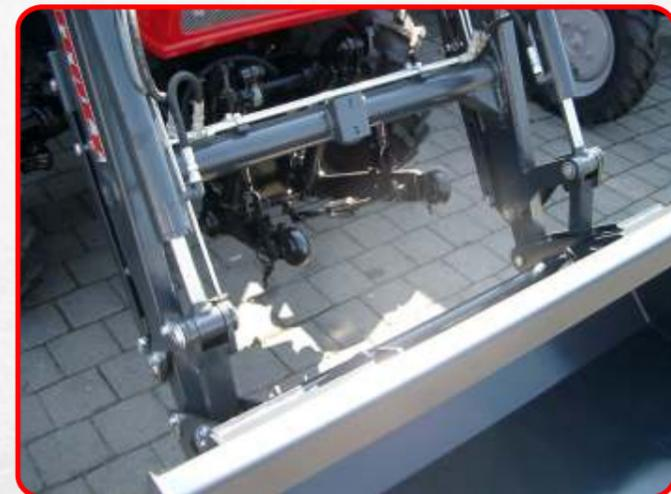
Die Frontladerschwingen können bei Bedarf werkzeuglos demontiert werden.
