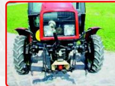
Frontkraftheber und Frontzapfwelle
