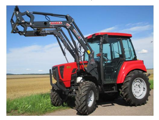
Frontlader Stoll mit Parallelführung Solid 30-16P, Schaufel 1,6m, Bedienung über Einhebelsteuergerät Stoll
