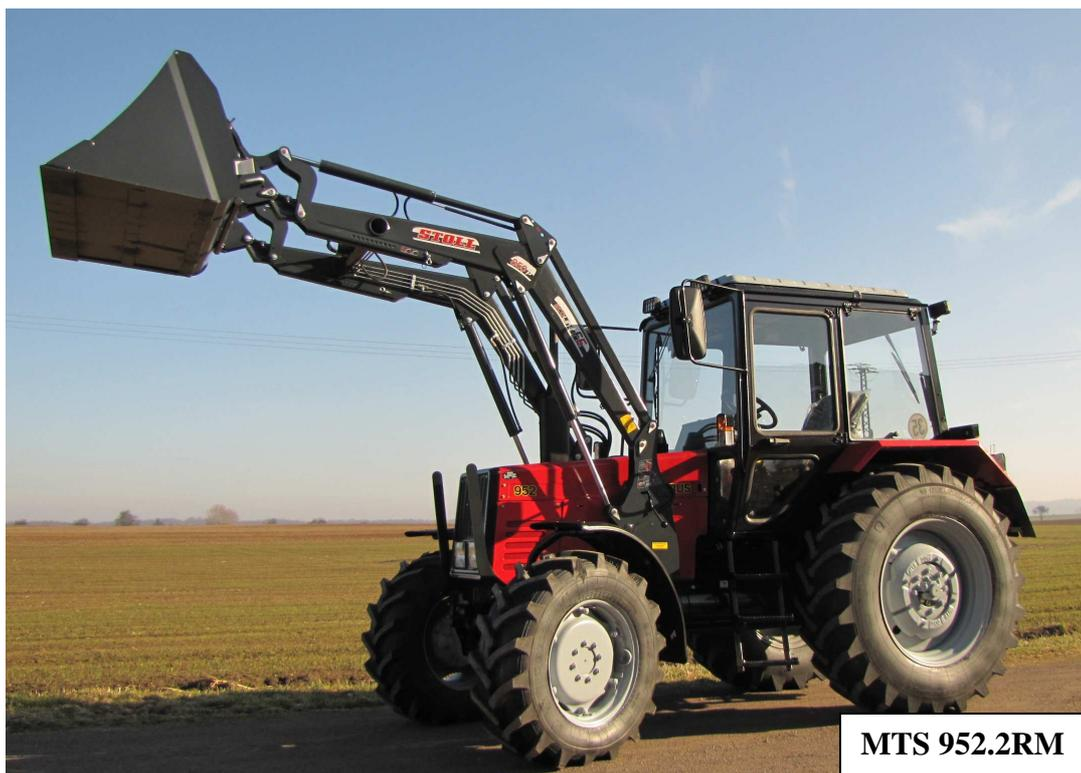
**Frontlader mit Parallelführung Solid 38-20P,
