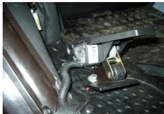
Motorsteuerung über elektronisches Gaspedal
