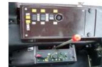
MTS 1221.3 oder 1221.4 Bosch EHR, elektrohydraulische Bedienung von Zapfwelle, Allrad und Differentialsperre
