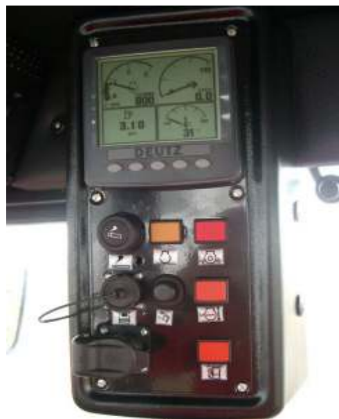
Das LCD - Anzeigedisplay informiert über alle aktuellen Motordaten wie Temperatur, Momentanverbrauch, Drehzahl, Öldruck, Betriebsstunden...
