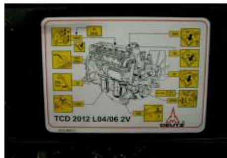
Motortyp TCD 2012 L06 2V Abgaswerte Stufe IIIA 142 PS im MTS 1221.4 160 PS im MTS 1523.4
